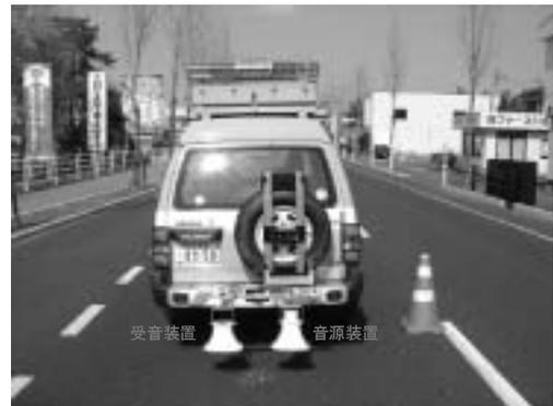
写真-3 音源・受音装置
