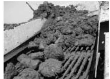
写真-6 籠石が混入した発生土
