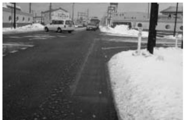
写真-9 凍結抑制舗装部の圧雪状況(上り線)
