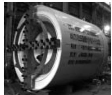
写真-1 φ4070 回収型掘進機
