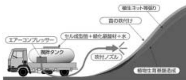
図-1 バイオ・セル・ショット工法施工概念図
