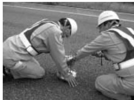
写真-2 現場透水量の測定
