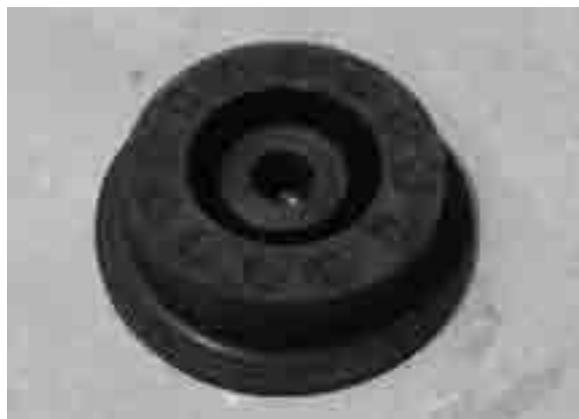
写真-2 防振ゴムの概観
