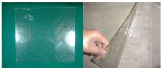
写真 - 1 紫外線硬化型 FRP シート
