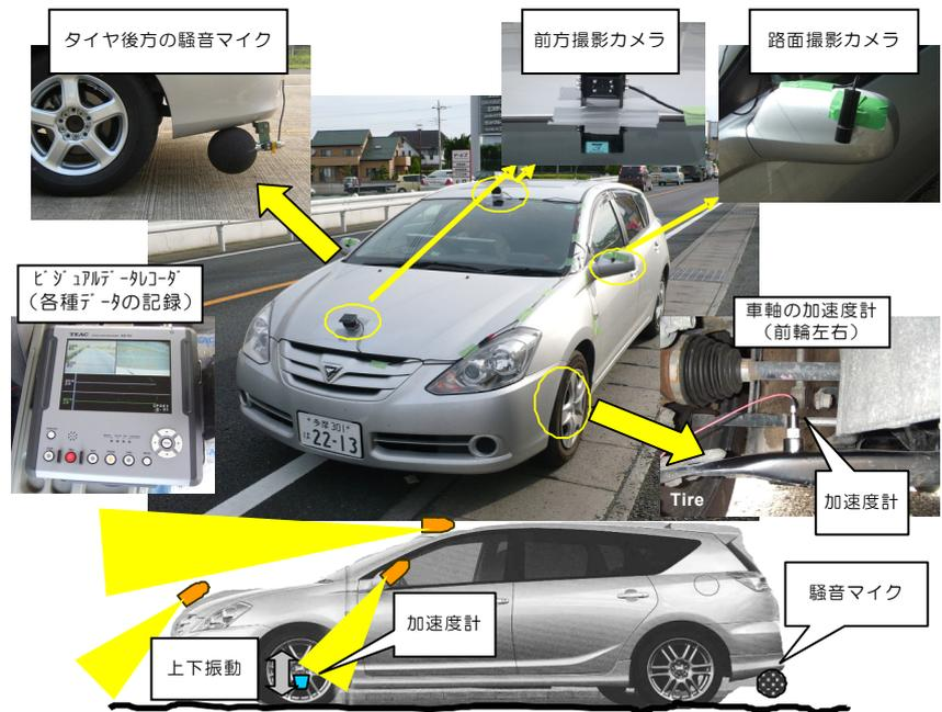
図-1 簡易型測定車の概要
