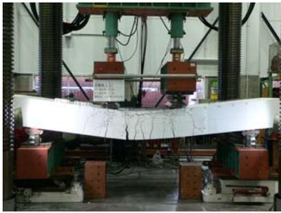
写真-2 平板実物大曲げ試験状況
