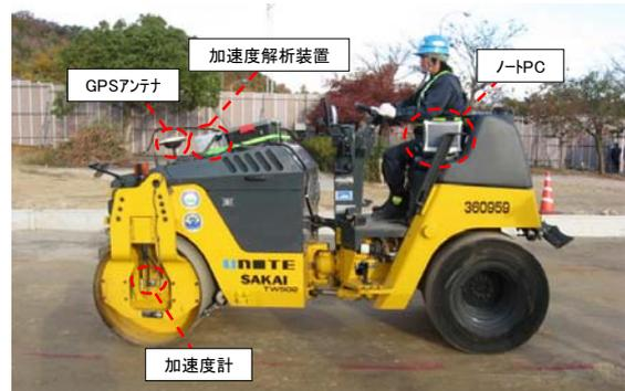
図-6 4トンコンバインドローラ
