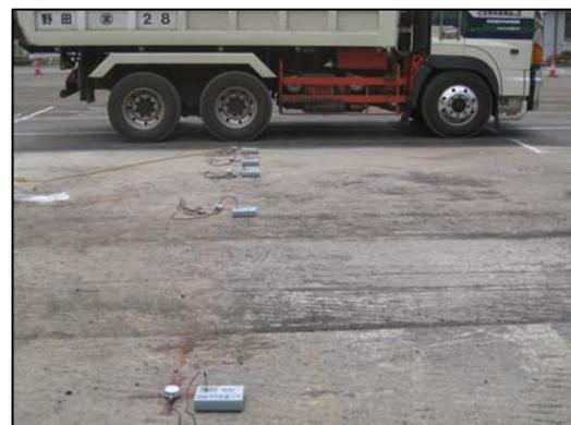
写真－4 振動レベル測定（段差通過時）
