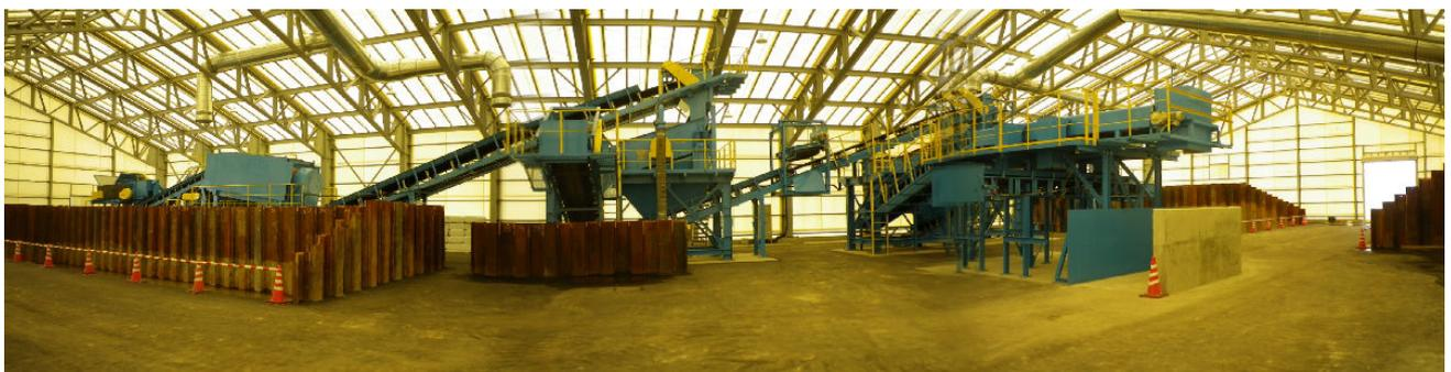
写真一 2 負圧管理大型テント内に設置した選別処理施設
