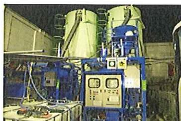
写真一 6 通信・遠隔操作装置
