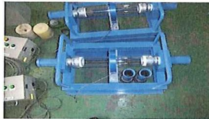
写真一 4 仕切り材検知装置
