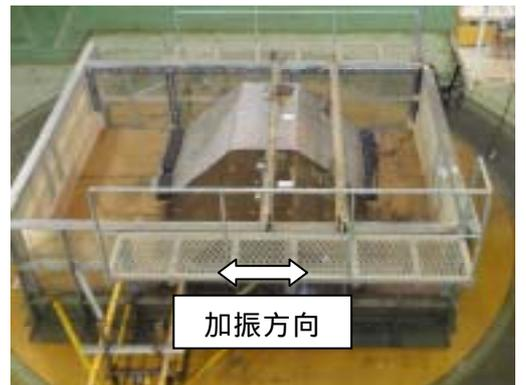
写真 - 6 水中振動台と堤防模型
