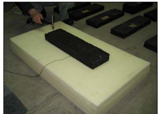
写真－2 振動減衰特性試験の状況
