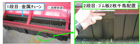
写真-4 飛石防止装置
