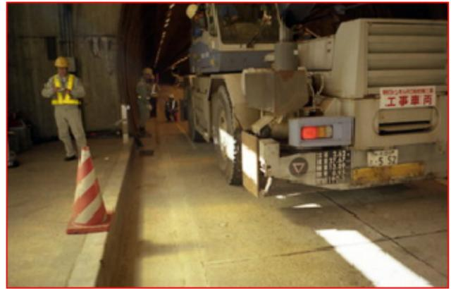
写真-3 朝日トンネルの載荷試験状況
