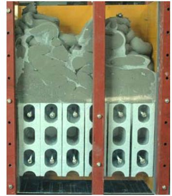
写真－3 非漏出性試験状況
