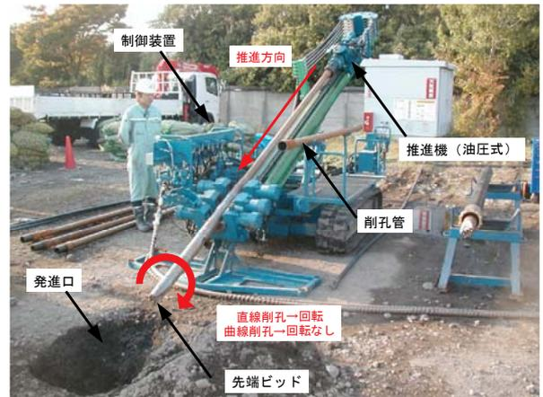
図-1 専用削孔機
