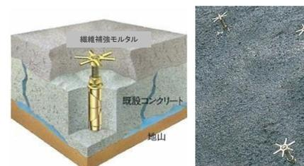
図-3 せん断ボルト概念図及び設置例
