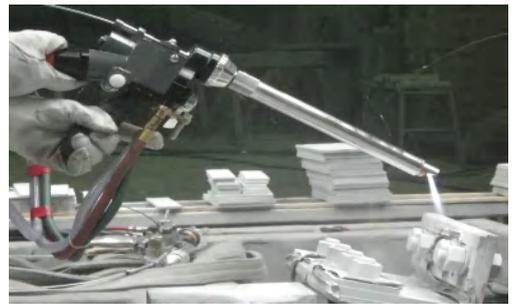
写真-4 狭隘溶射ガンの施工状況
