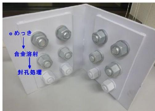
写真-3 二重防錆ボルトの施工手順
