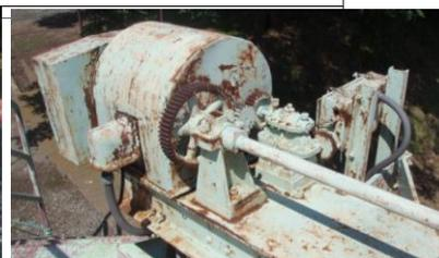
写真-3 電動機、連結シャフト
