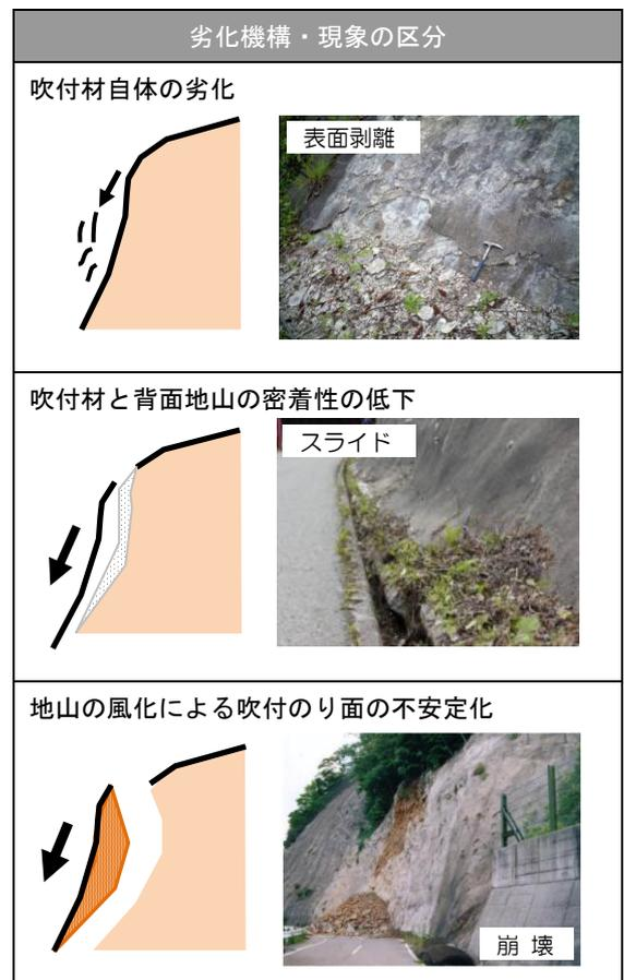
図-1 吹付のり面の劣化機構及び劣化現象
