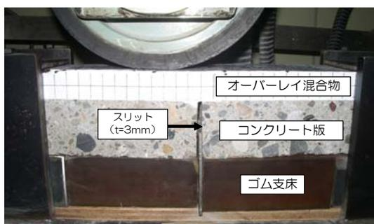
写真-1 クラック貫通試験状況
