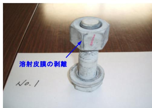
写真-2 溶射高力ボルトの締付けによる被膜剥離
