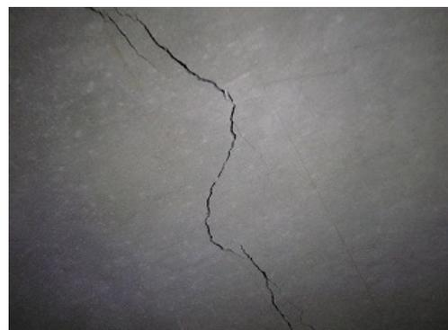
(b) 曲げ試験後の壁面材の表面
