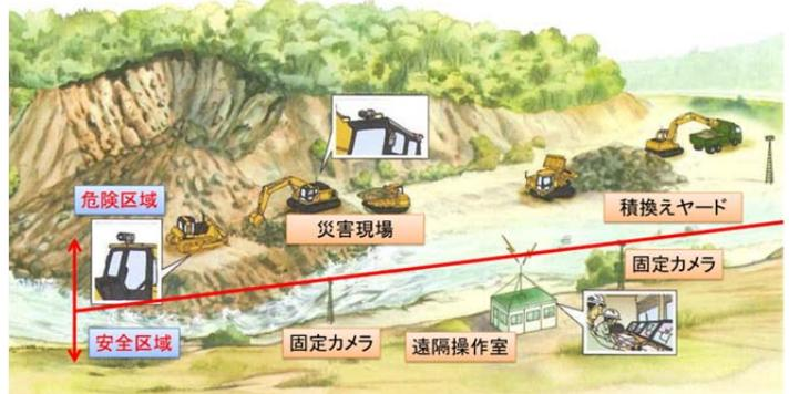
図-1 無人化施工概要図
