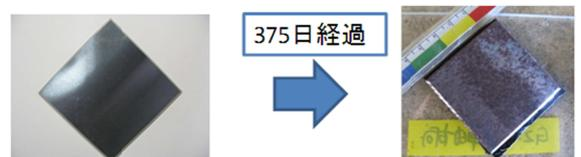
図-9 鋼板試験片の腐食状況 (カバー内)
