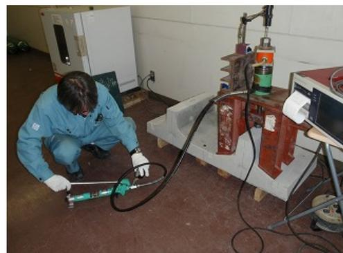
写真-4 連結穴の引張試験
