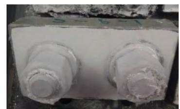
a) アルミニウム・マグネシウム合金溶射
