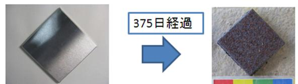
図-8 鋼板試験片の腐食状況 (鋼桁外)
