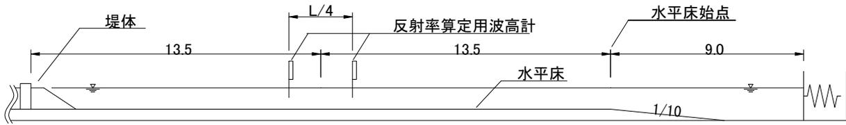
図-1 反射率測定実験の造波水路内の状況 (模型量, 単位: m)
