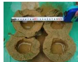
実験ケースは、表-2 に示すように、Case1：地盤改良を行わないケース、Case2：相対密度を 90% に締固めたケース、Case3：改良率 70% で部分改良を行うケース、Case4：シェル型浸透固化処理工法の適用ケースの 4 ケースを選定した。
