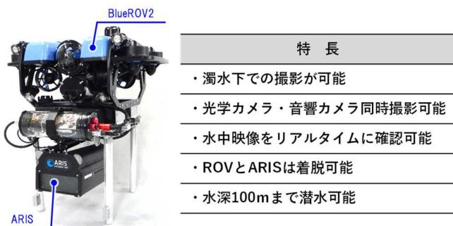
図-2 音響カメラ搭載型 ROV
