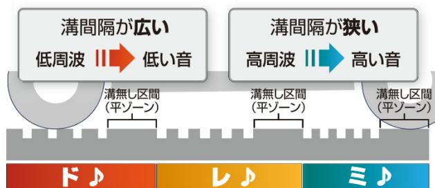
図-1 音の出る仕組み
