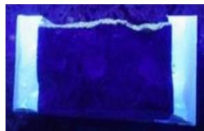
写真-2 浸透防水型薄層表面処理
