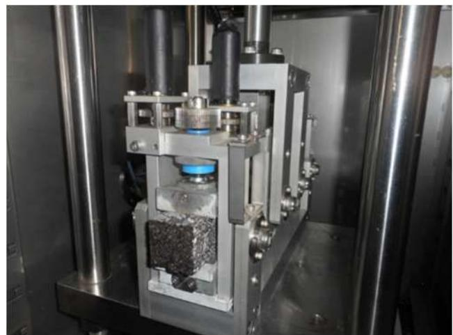
写真-2 曲げ疲労試験
