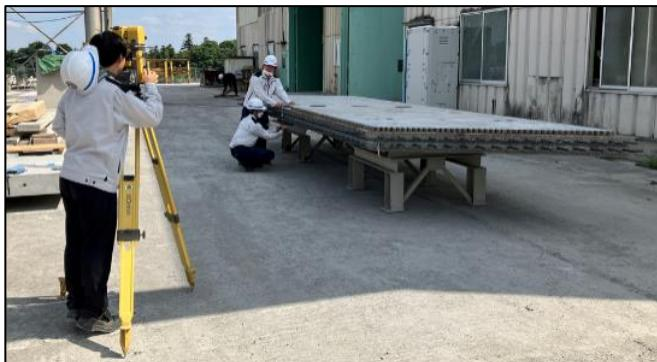
写真-2 製作した床版の計測状況
