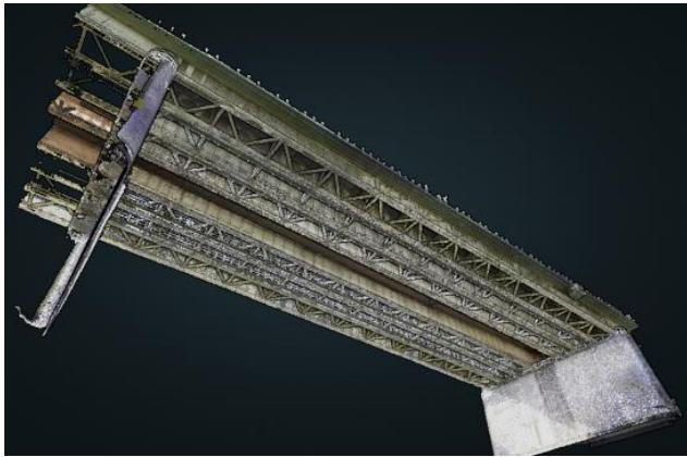
図-7 既設橋梁計測点群データ
