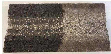
写真一1 摩耗抵抗性試験後状況 (処方A)
