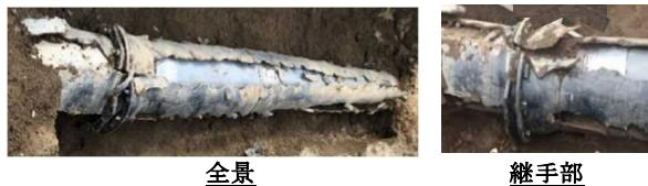
写真-7 ダクタイル鉄管（K形）破碎状況
