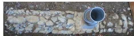
写真-5 鉄筋コンクリート管 破碎状況（全景）
