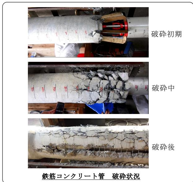
写真-2 室内破碎試験（パイロットタイプ）
