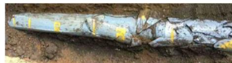
写真-6 硬質塩化ビニル管 破碎状況（全景）
