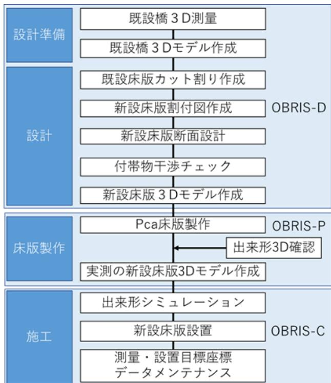
図-13 OBRIS を用いた業務フロー遷移図
