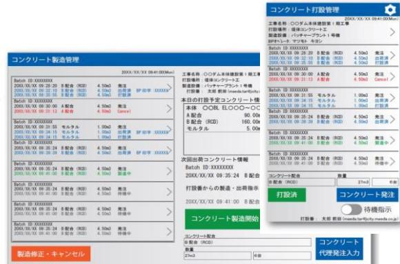
図-5 打設管理システム概要
