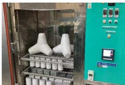
図-2 炭酸化実験の状況<sup>5)</sup>
