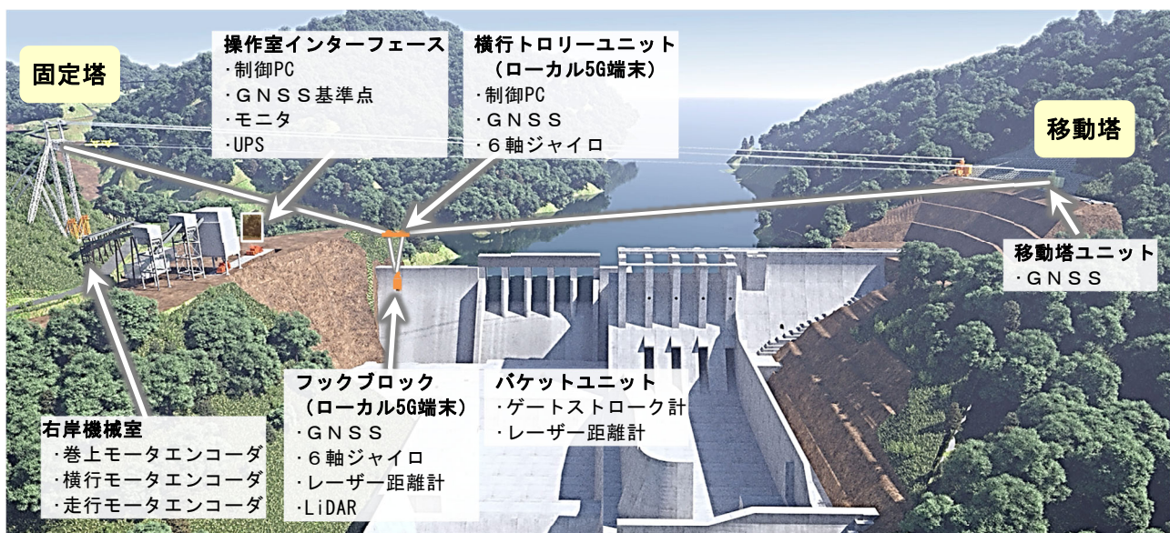
図－３ 弧動型ケーブルクレーン自律運転システム
