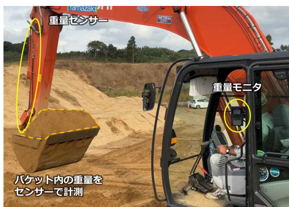
写真－１ 荷重判定装置取付イメージ
